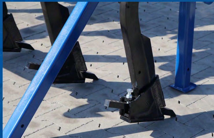
Dent ATLAS configuré pour travail en tant que sous-soleuse
