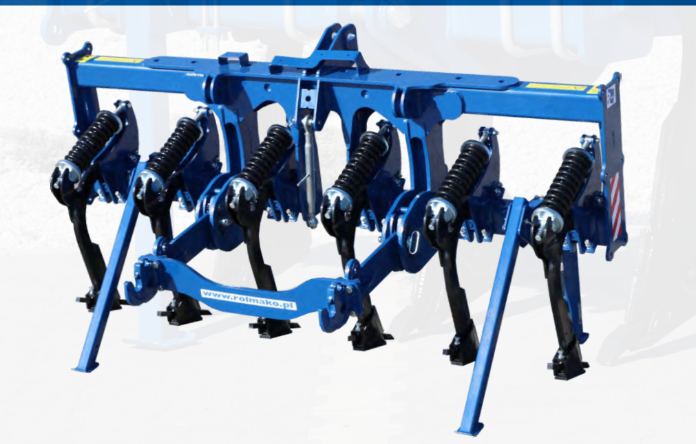
Dent ATLAS configuré pour travail en tant que sous-soleuse
